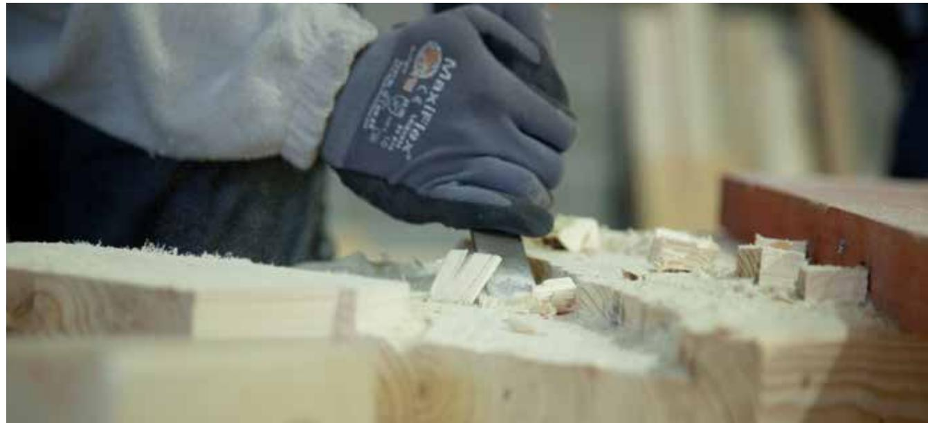
On réalise les finitions des découpes à la scie sauteuse et au ciseau à bois. Ensuite, on présente les lisses dans leur position d'utilisation pour procéder à la mesure et au marquage des perçages ; on marque d'une croix l'emplacement des montants pour les préforer.
