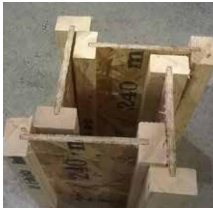
Vóór het op maat zagen van de verschillende stijlen, gebeurde het aftekenen met behulp van mallen die het aantal verrichtingen aanzienlijk verminderen. De maten werden gemakkelijk overgebracht, zo dikwijls als nodig was.
